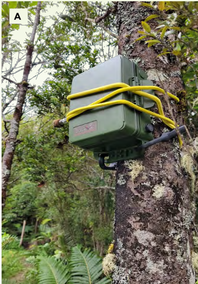
Métodos de muestreo utilizados para el registro de murciélagos en el AICOM Parque Katalapi, Pichiquillaie, Los Lagos, Chile: A) detector acústico modelo Song Meter SM4BAT-FS (Wildlife Acoustics, EE. UU.), y B) red de niebla. Fotografías: Annia Rodríguez-San Pedro y Juan Luis Allendes
