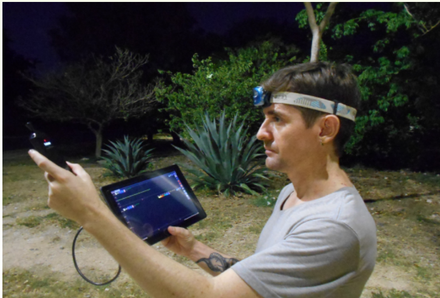
Micrófono ultrasónico USB Pettersson M500 (Pettersson Elektronik AB, Suecia), conectado a una Tablet PC con sistema operativo Windows (© Microsoft). El sonido detectado, específicamente los pulsos de ecolocalización, se visualiza en tiempo real y se almacena a través del programa BatSound Touch Lite (Pettersson Elektronik AB, Suecia). El equipo fue adquirido con una subvención del Instituto de Ciencia, Tecnología e Innovación del Estado de Chiapas (ICTIECH), a través del Sistema Estatal de Investigadores (SEI). Fotografía: Elida Leiva
